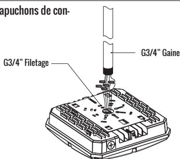
2. Tournez la gaine pour serrer le raccord avec le luminaire. L'installation est terminée.
