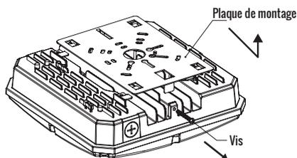
2. Utilisez les vis pour verrouiller la plaque de montage à la boîte de connexion encastrée.
